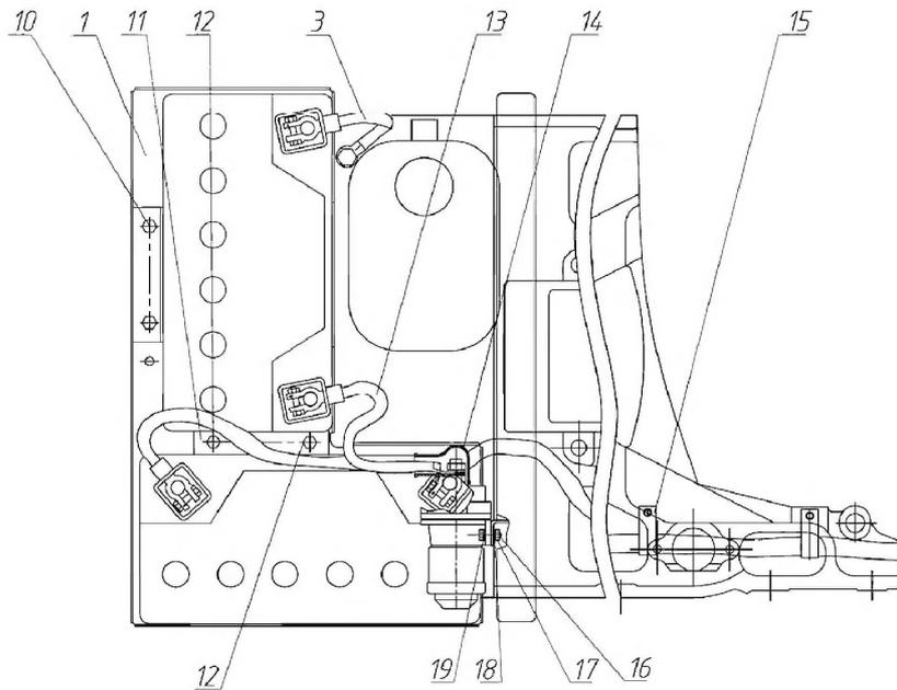
Рис. 37.8. Установка аккумуляторных батарей
