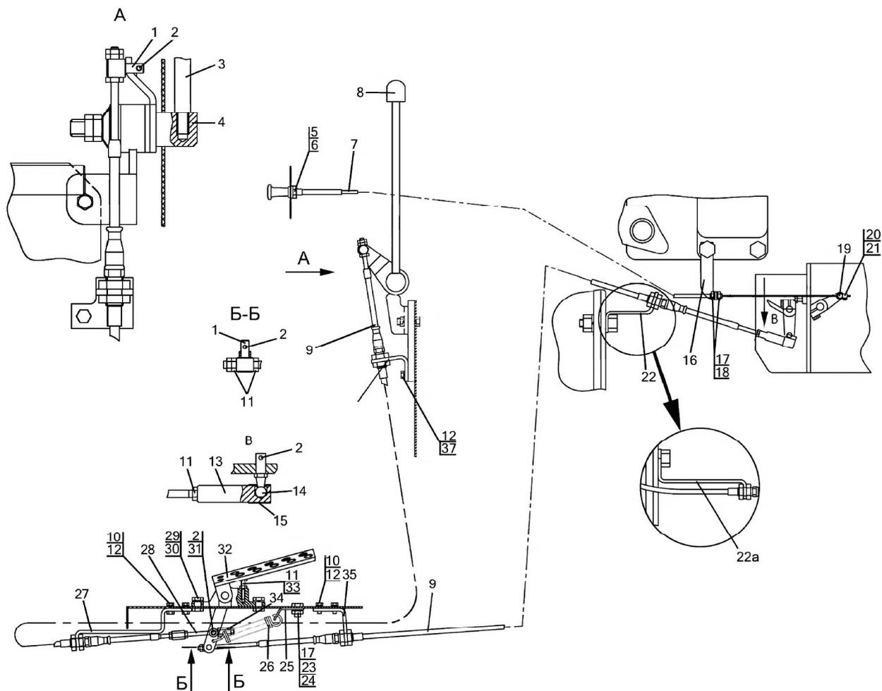
Рис. 11.2. Управление подачей топлива
