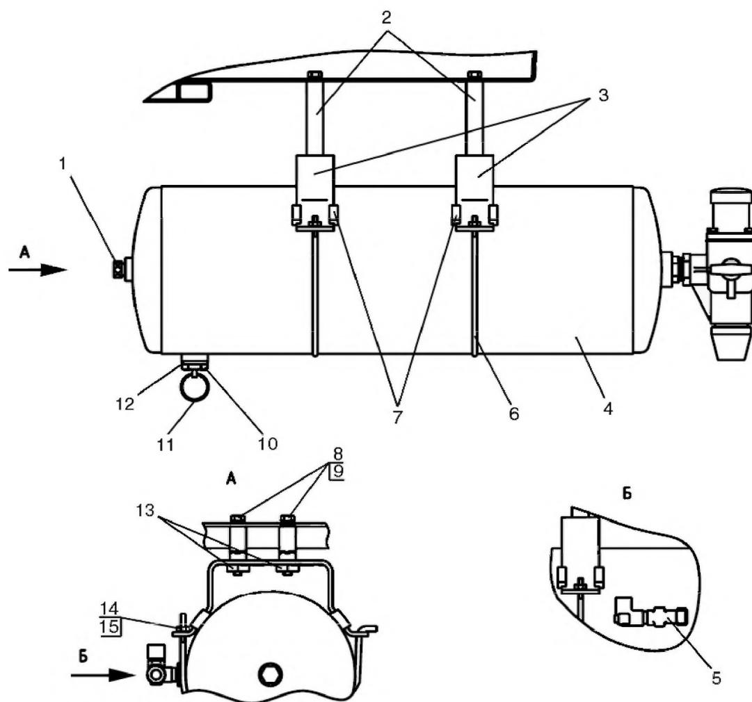
Рис. 35.6. Баллон (для однопроводного пневмопривода тормозов прицепа)
