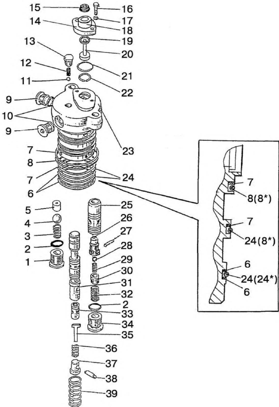
Рис. 46.7. Распределитель гидроподъемника
