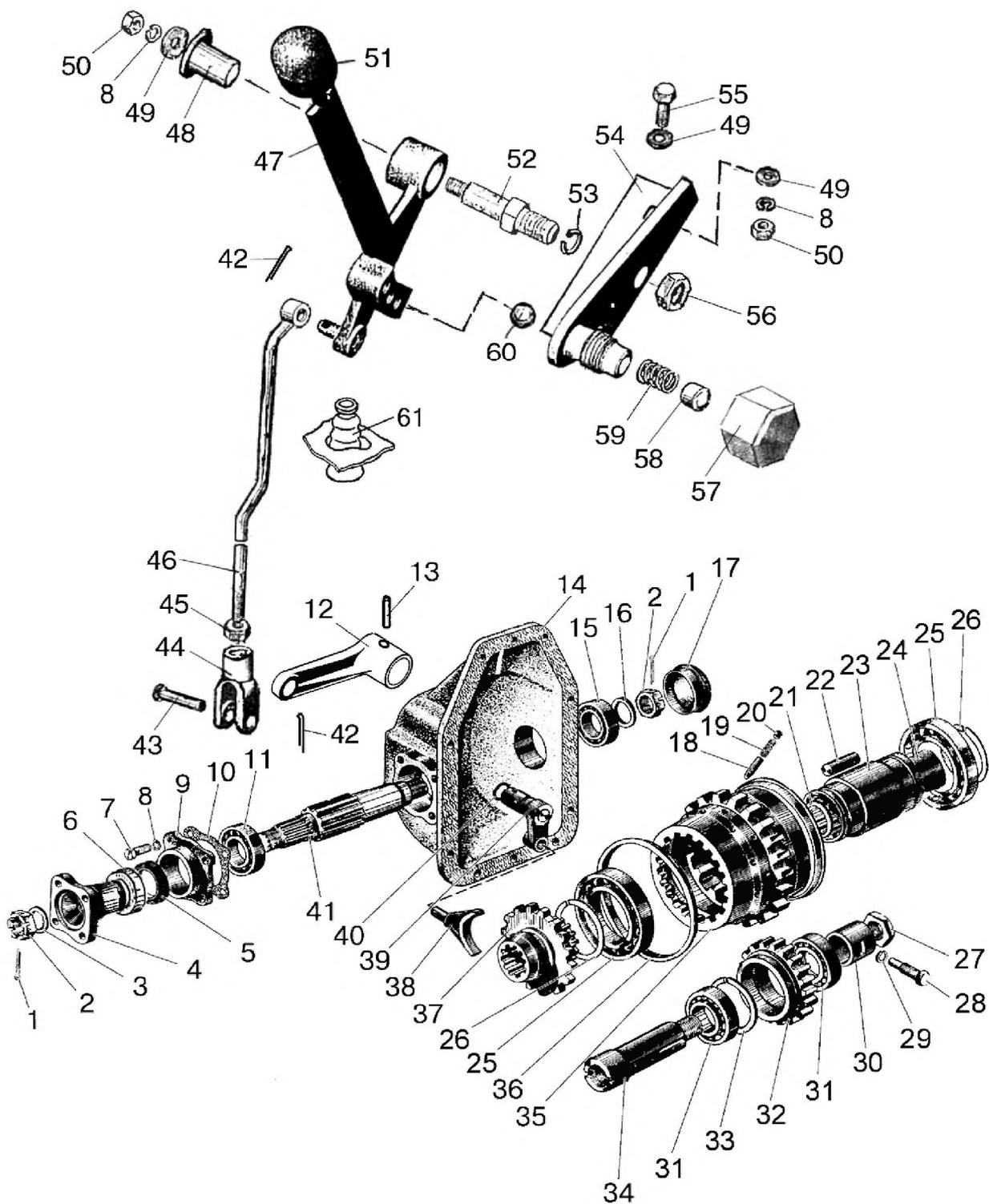
Рис. 18.1. Раздаточная коробка привода ПВМ. Управление раздаточной коробкой
