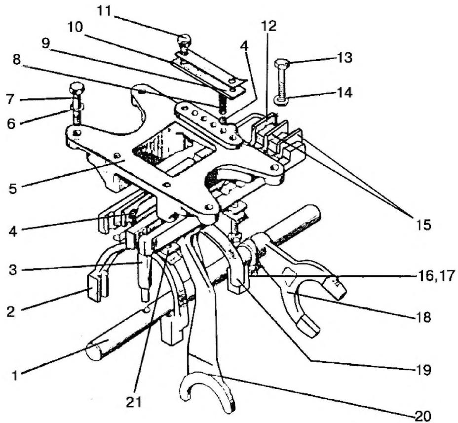
Рис. 17.10. Механизм управления синхронизированной КП. Корпус вилок
