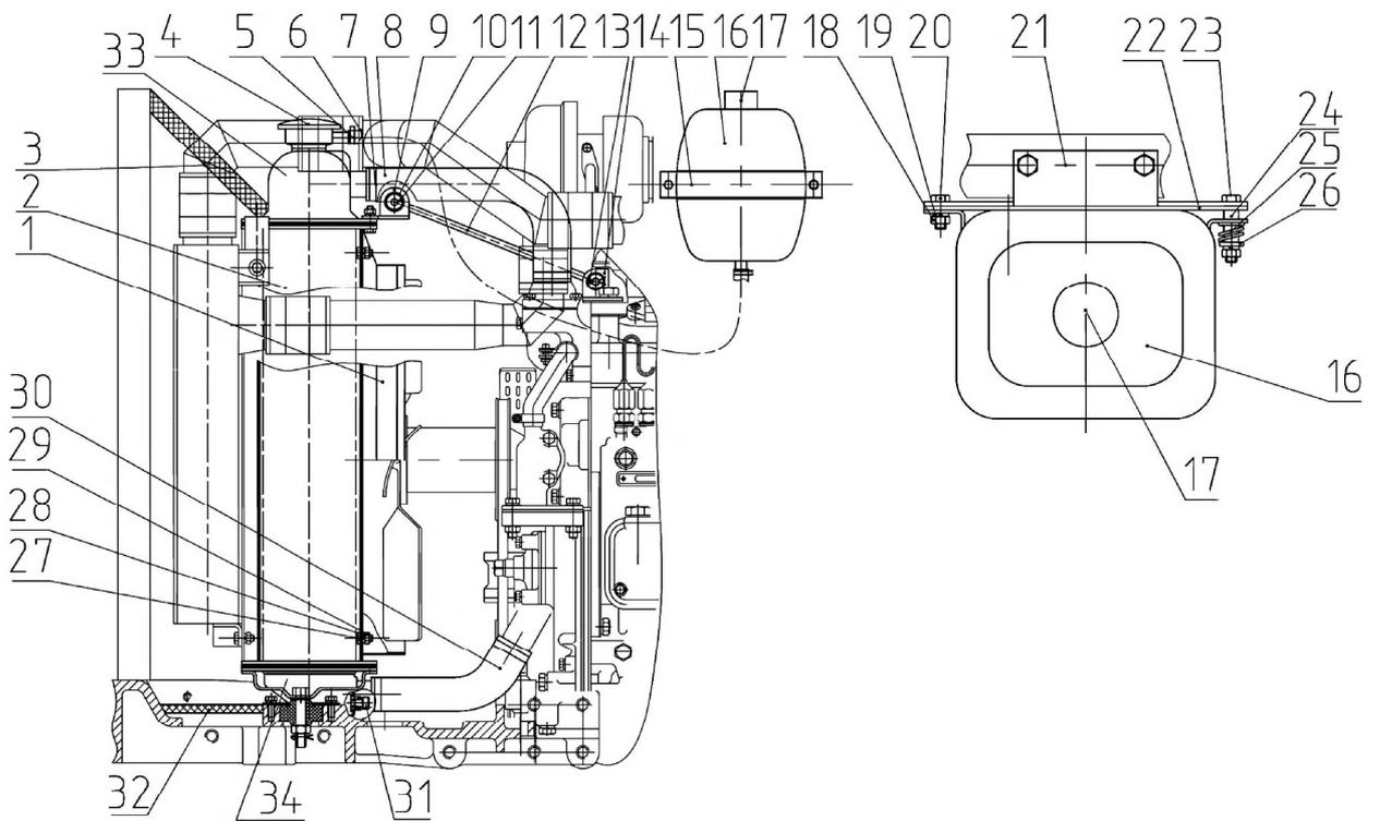
Рис.13.3. Блок охлаждения (для трактора «БЕЛАРУС-821.3/921.3»)
