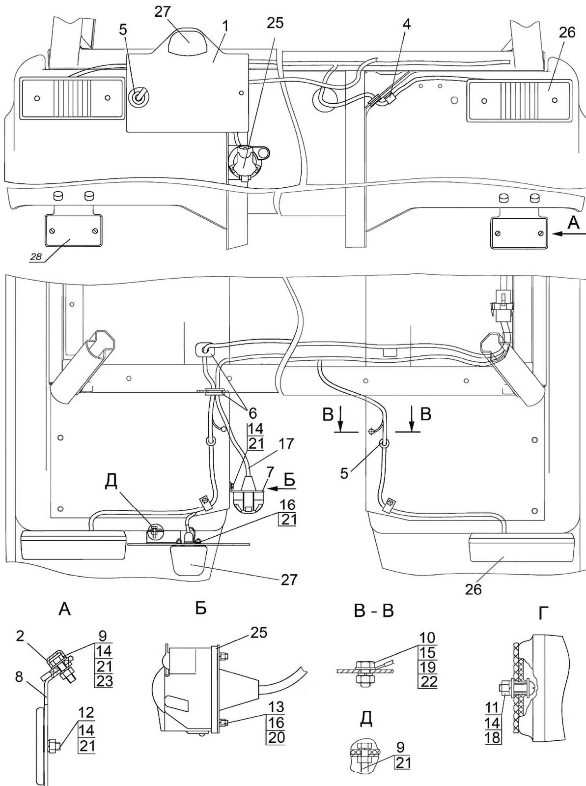
Рис. 37.5. Фонари задние, розетка, фонарь освещения номерного знака
