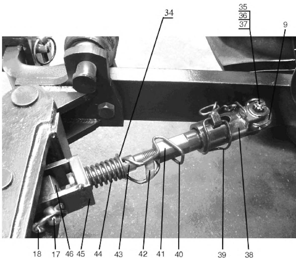
Рис. 46.12. Механизм задней навески
