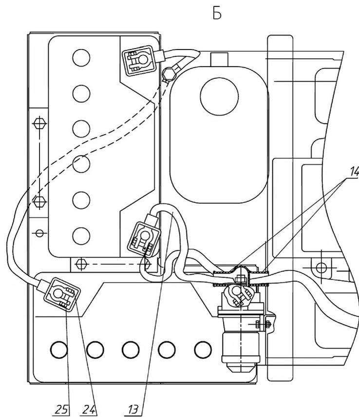
Рис. 37.9. Установка аккумуляторных батарей
