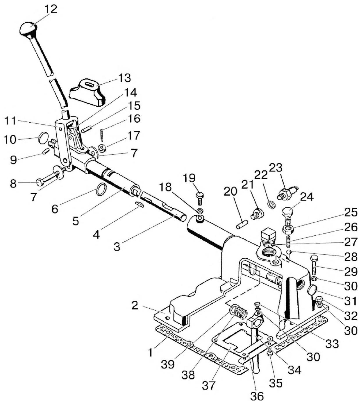
Рис. 17.11. Механизм управления коробкой передач. Крышка
