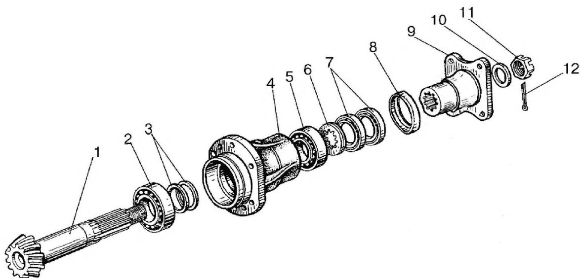
Рис. 23.2. Главная передача переднего ведущего моста
