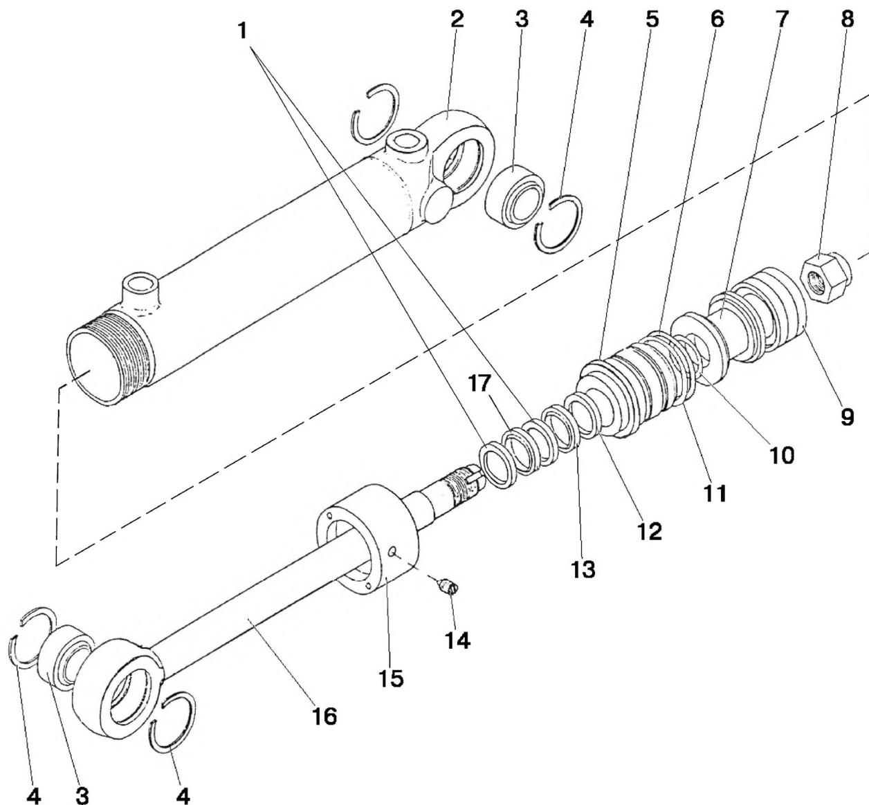
Рис. 34.2. Гидроцилиндр 50x25-200
