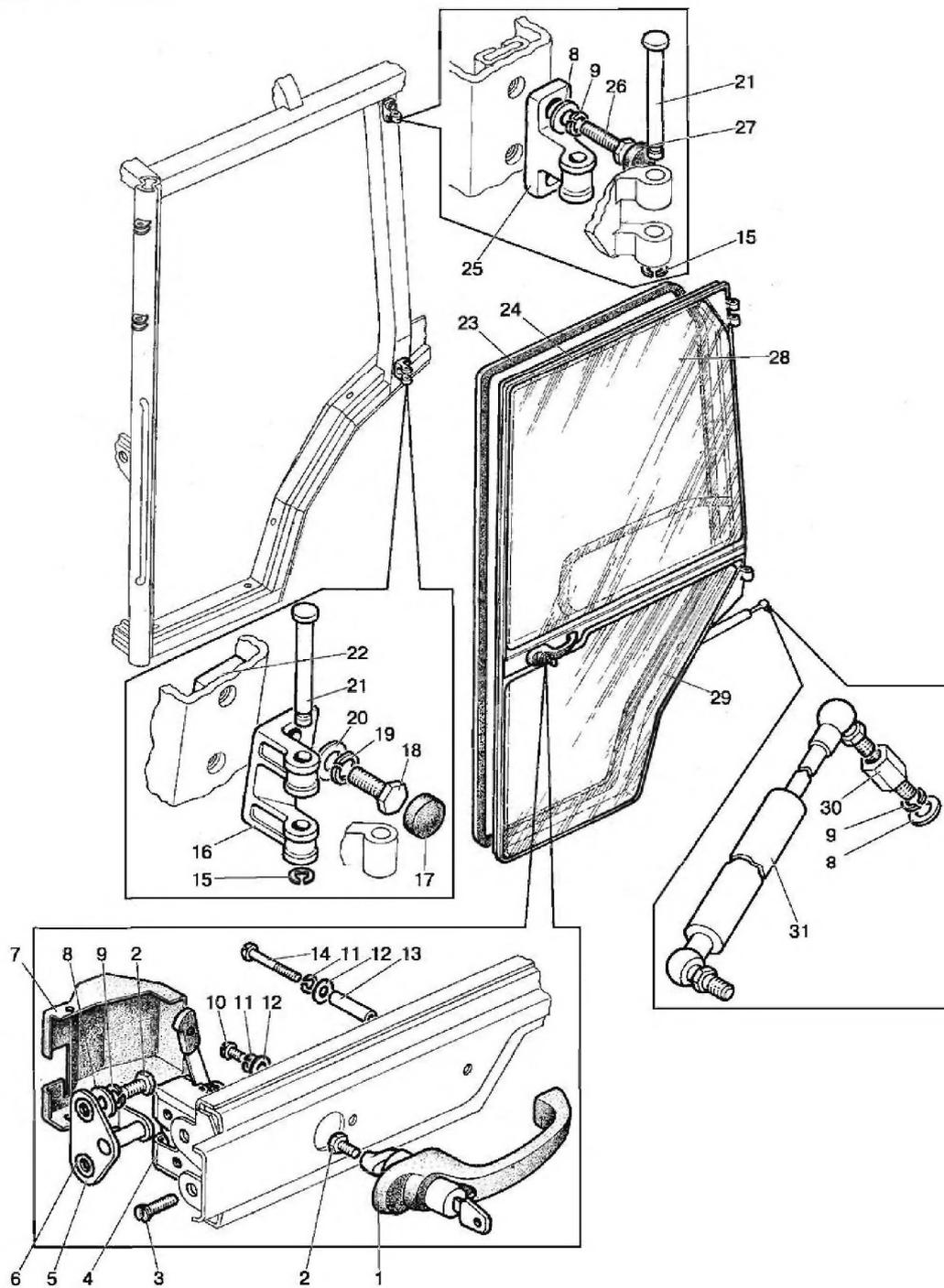
Рис. 67.4. Дверь кабины
