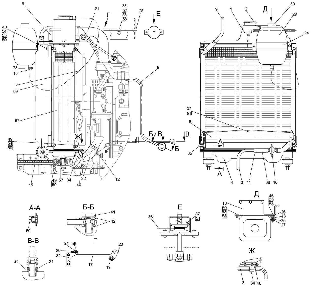
Рис.13.1. Блок охлаждения (для трактора «БЕЛАРУС-821/821.2»)
