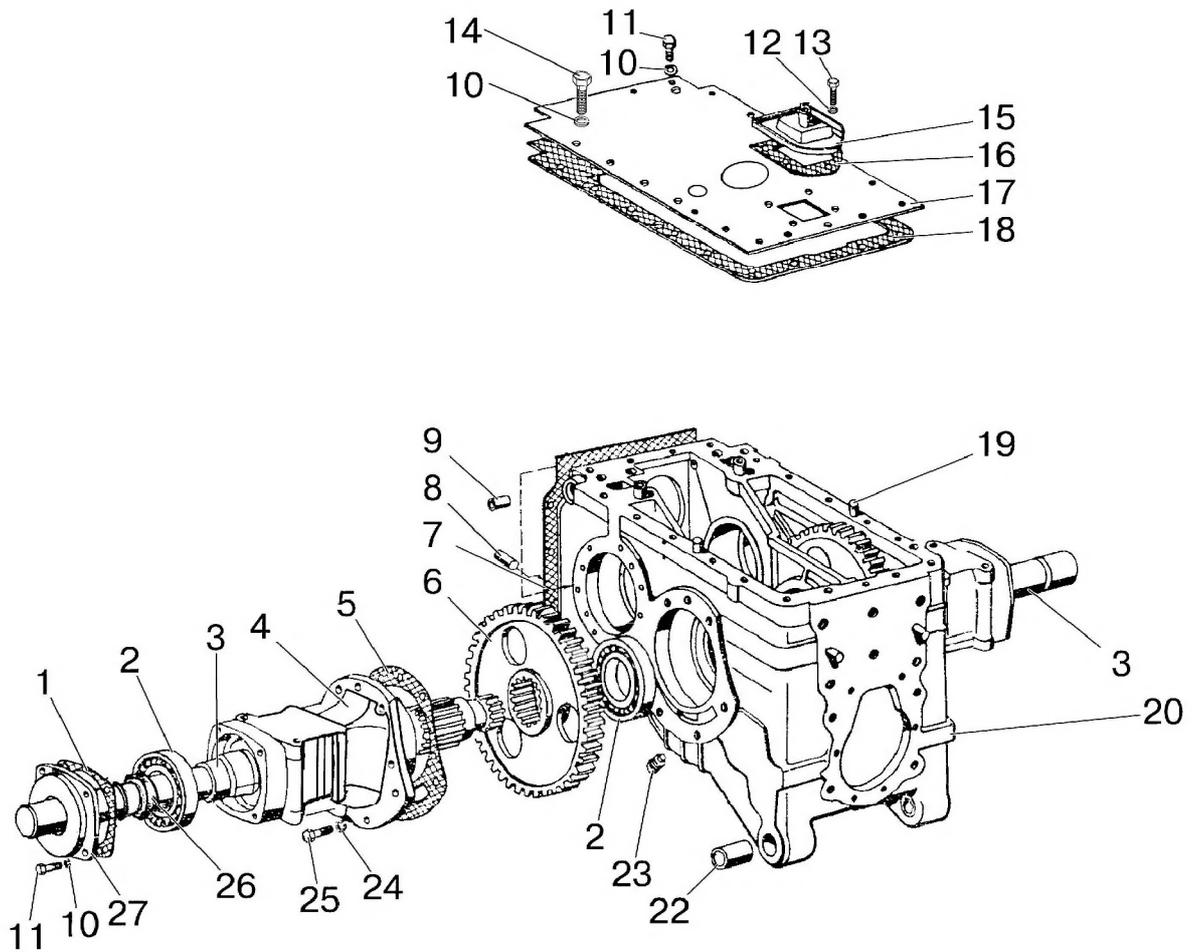
Рис. 24.1. Задний мост. Корпус заднего моста
