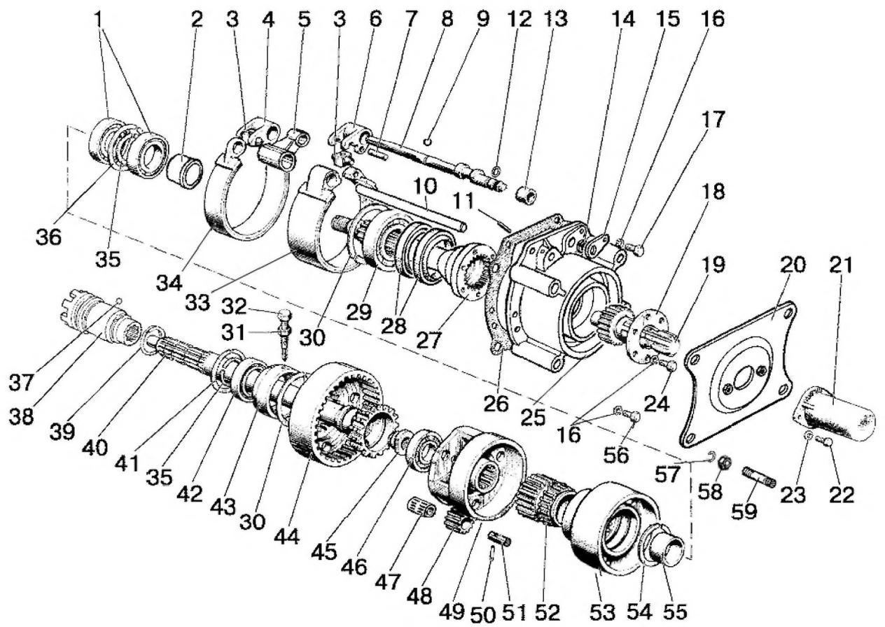
Рис. 42.1. Вал отбора мощности задний
