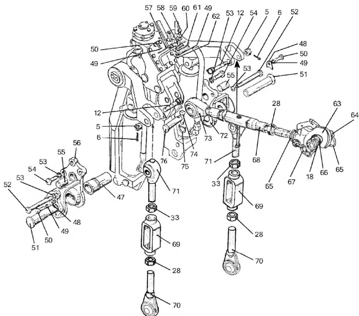
Рис. 46.13. Механизм задней навески
