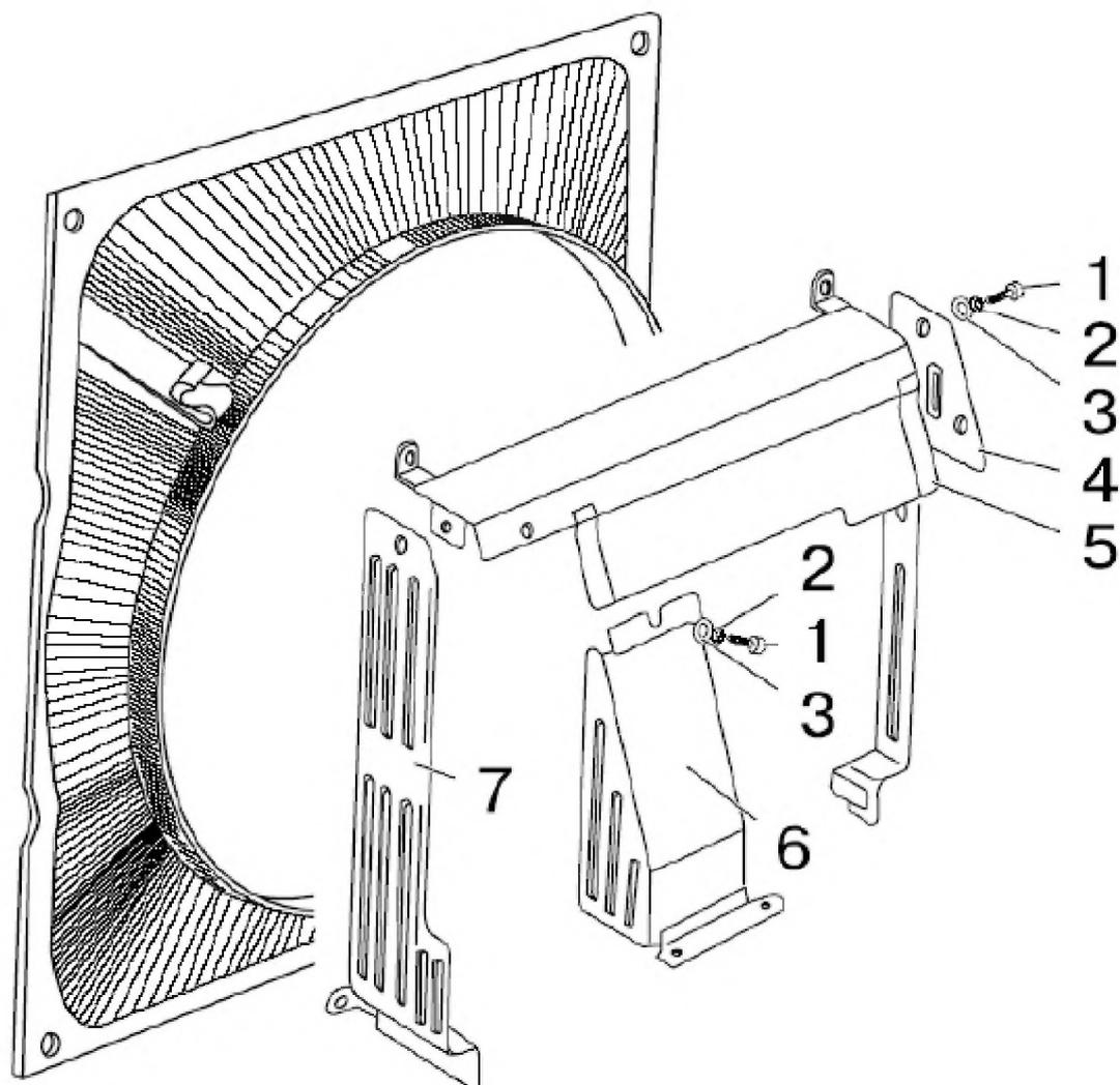
Рис. 13.4. Ограждение вентилятора (БЕЛАРУС-821/821.2/921/921.2)
