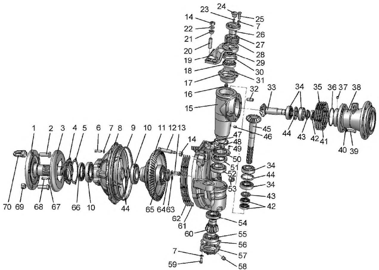
Рис. 23.3. Редуктор конечной передачи переднего ведущего моста
