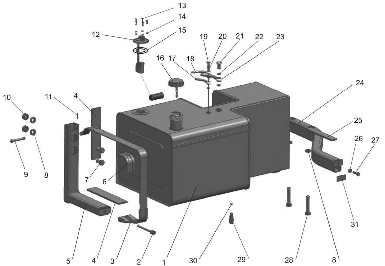
Рис. 11.1. Бак топливный
