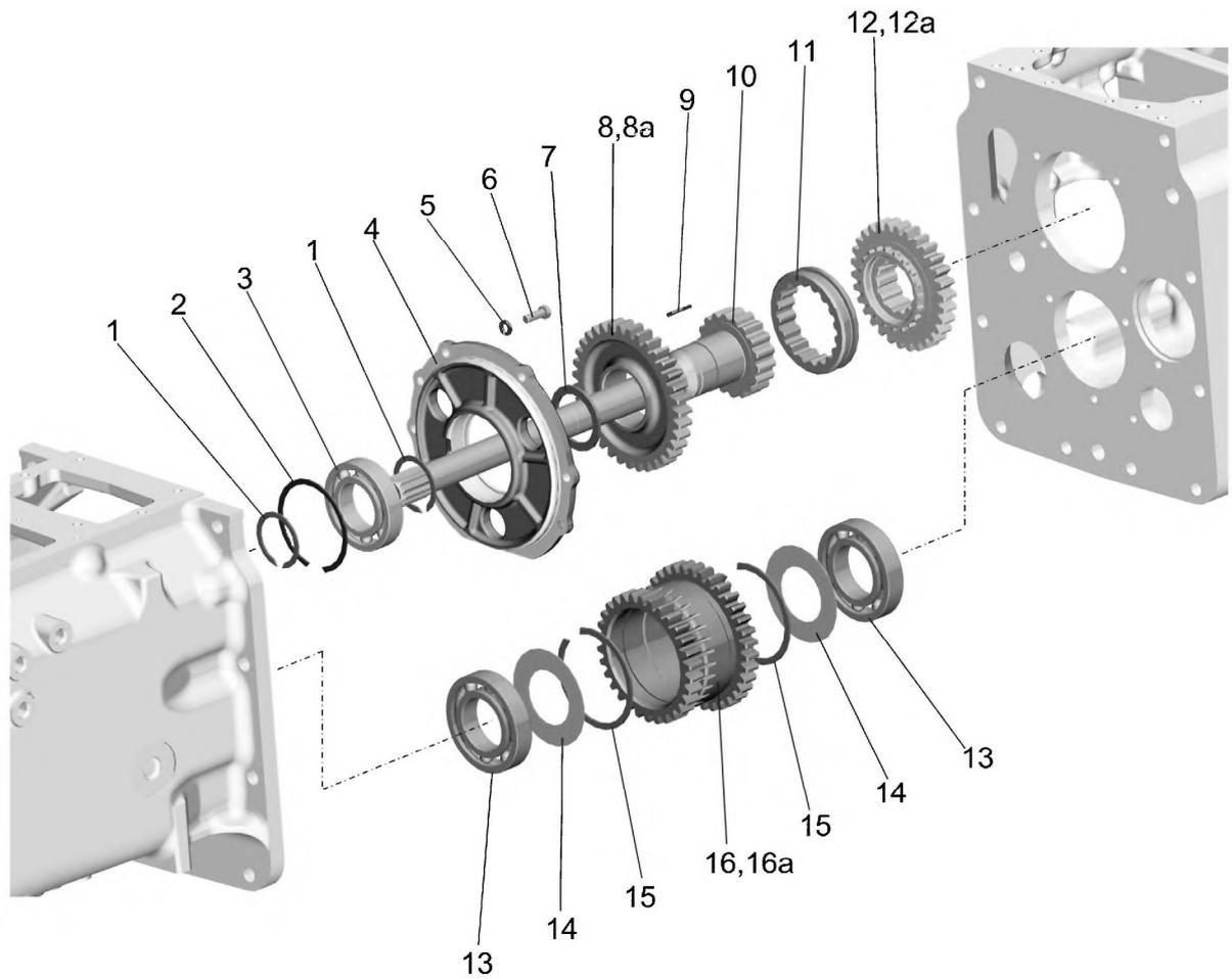
Рис. 17.1. Редуктор (для механических КП)
