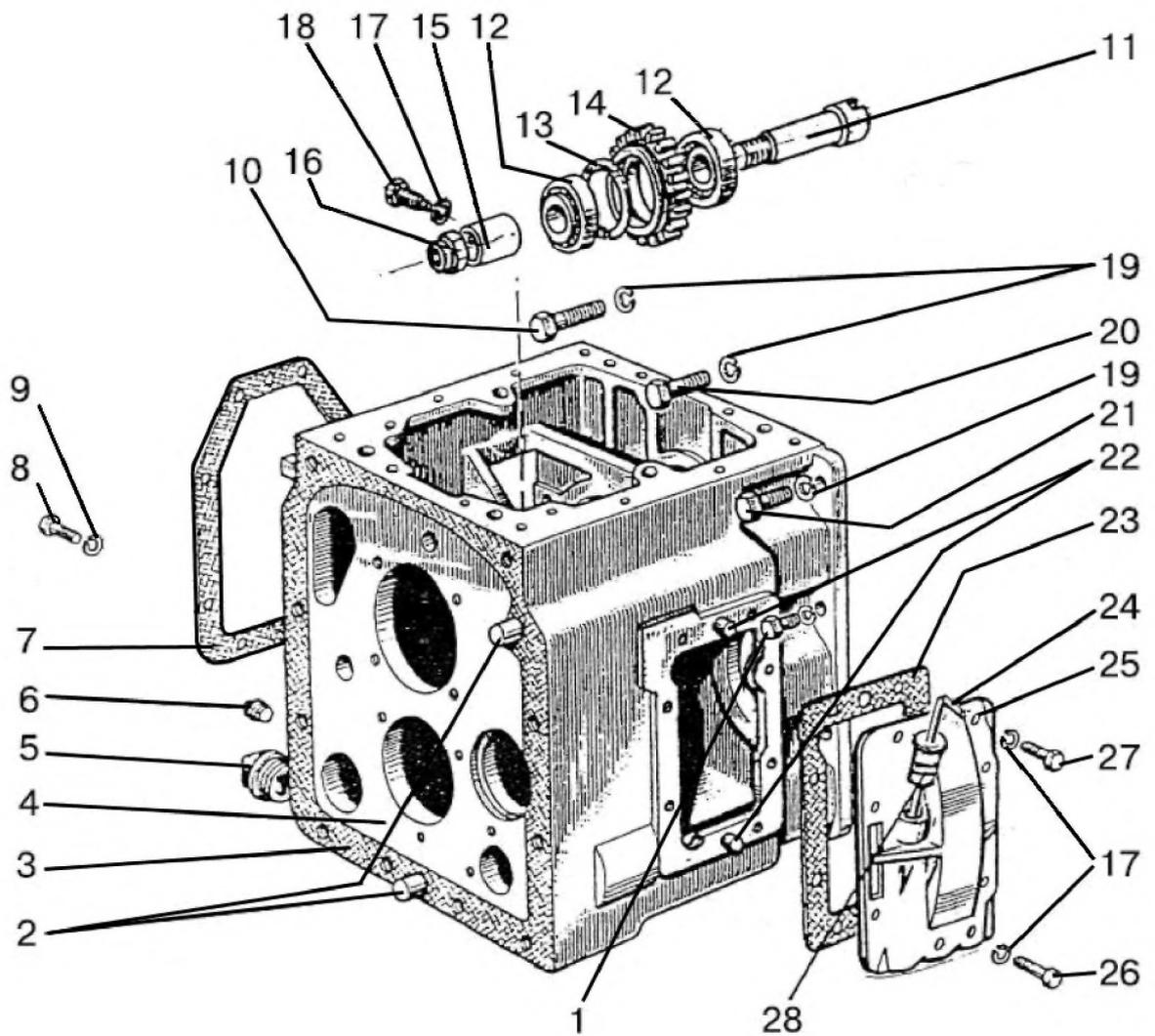
Рис. 17.4. Корпус КП. Привод ПВМ
