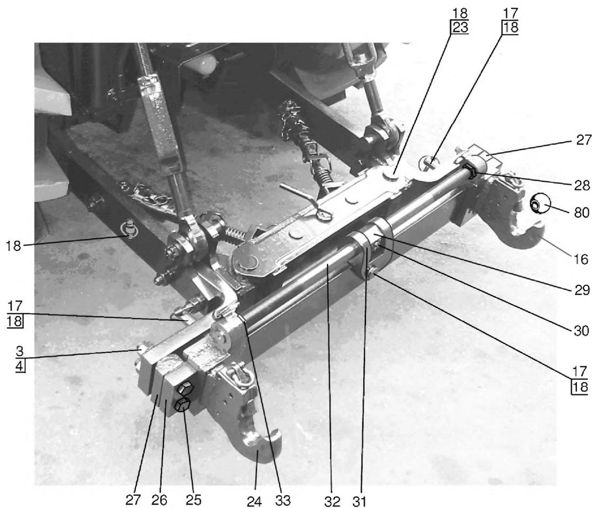
Рис. 46.11. Механизм задней навески
