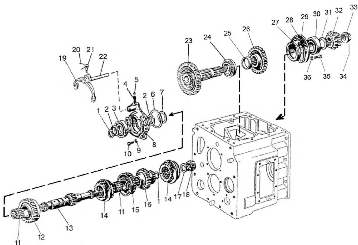
Рис. 17.6. Вал первичный и вал вторичный синхронизированной КП
