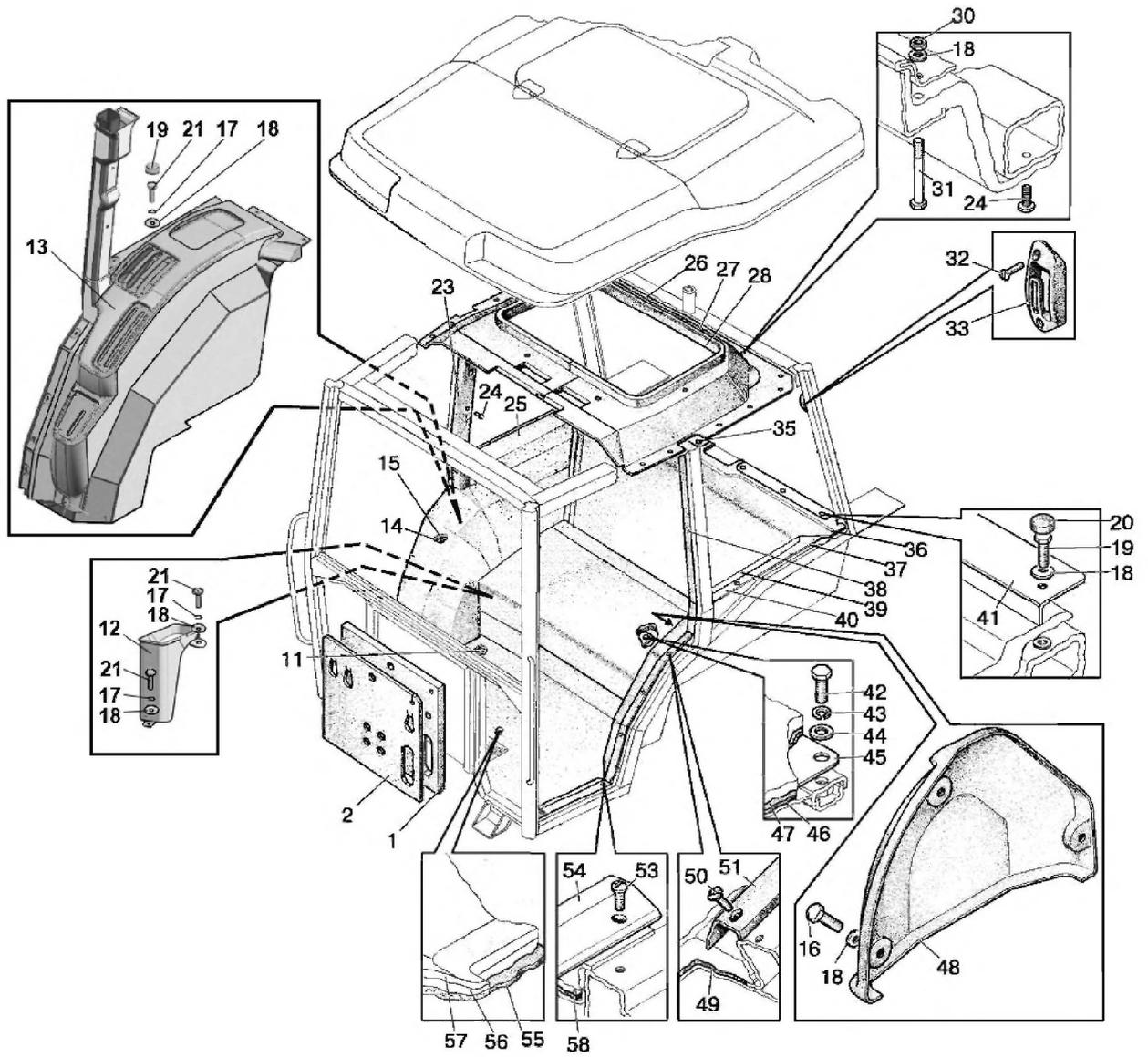
Рис. 67.3. Кабина трактора
