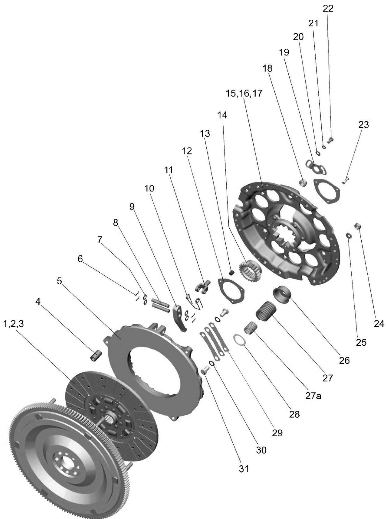
Рис. 16.1. Установка сцепления
