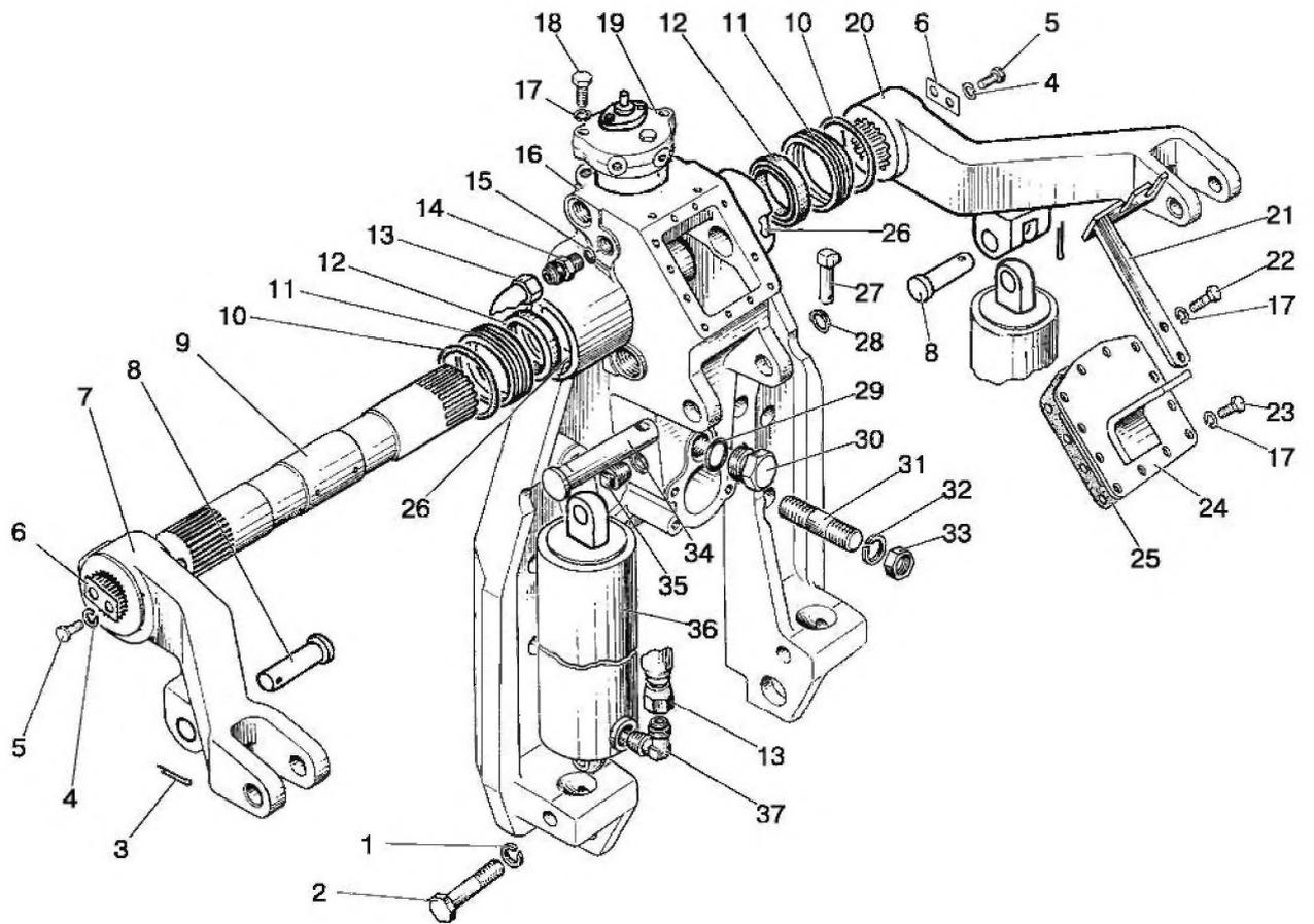
Рис. 46.9. Гидроподъемник
