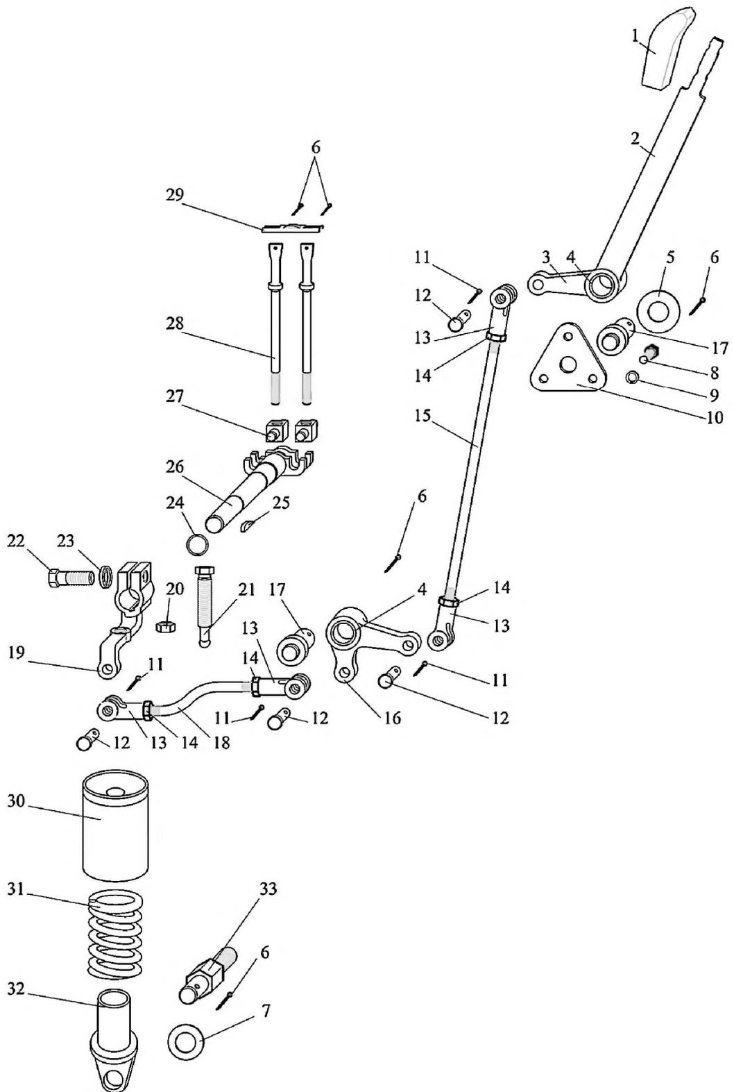
Рис. 42.3. Управление задним валом отбора мощности
