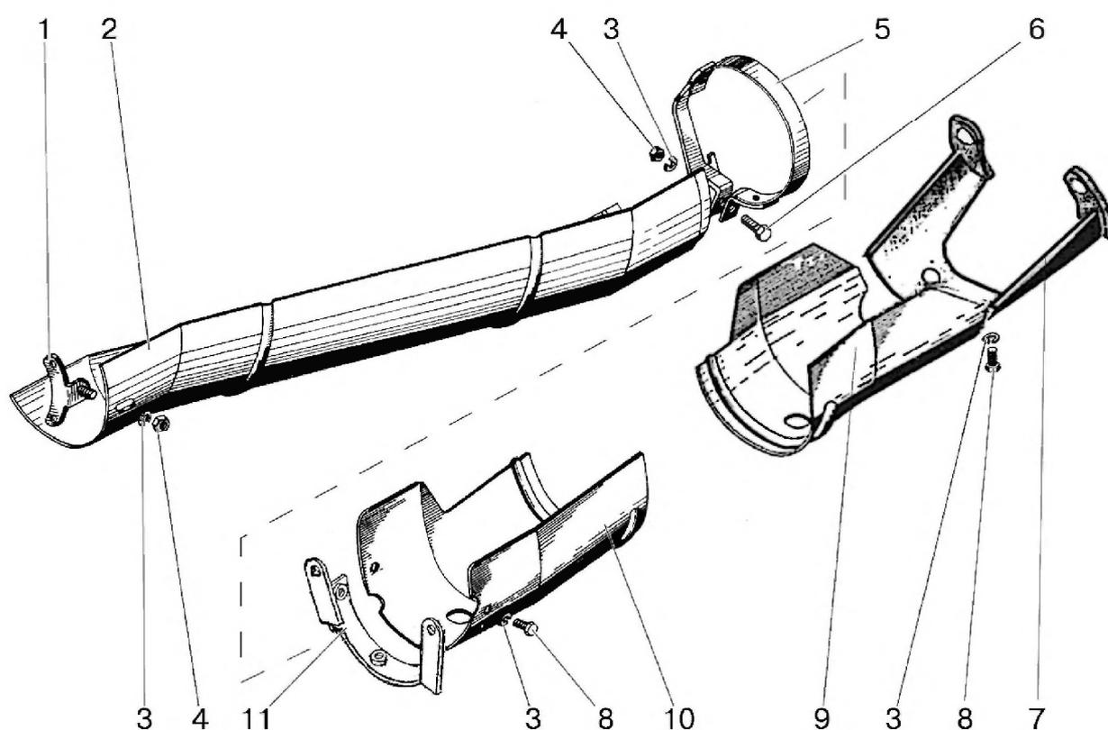
Рис. 22.2. Ограждение карданного привода
