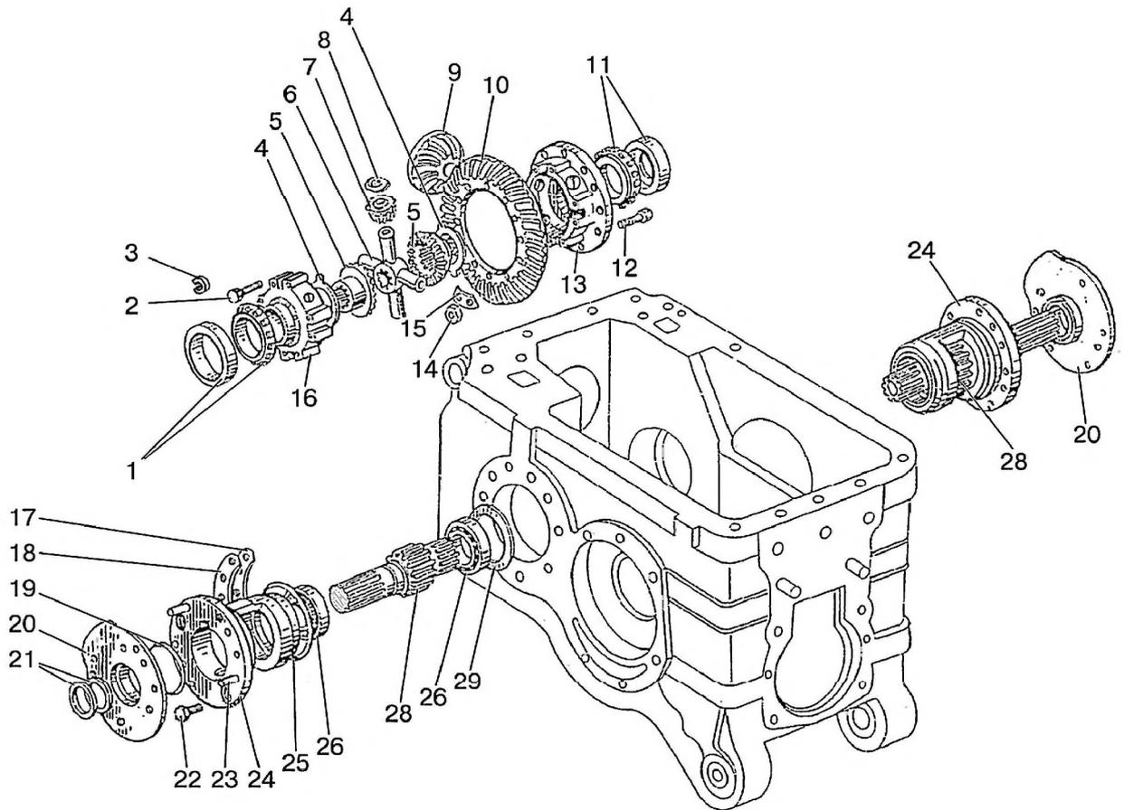
Рис. 24.2. Дифференциал. Главная передача. Стакан подшипников. Крышка стакана
