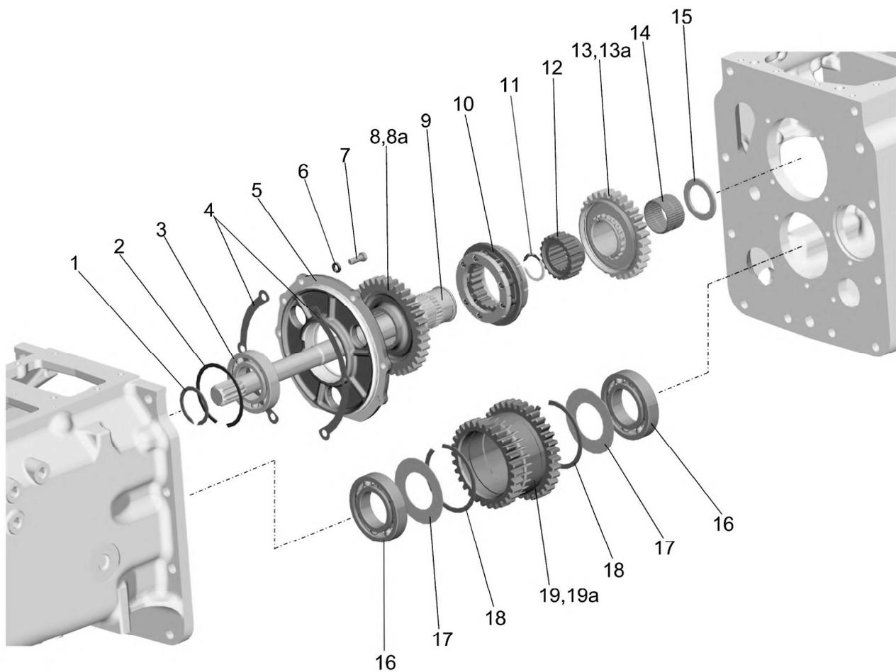
Рис. 17.2. Редуктор (для синхронизированных КП)
