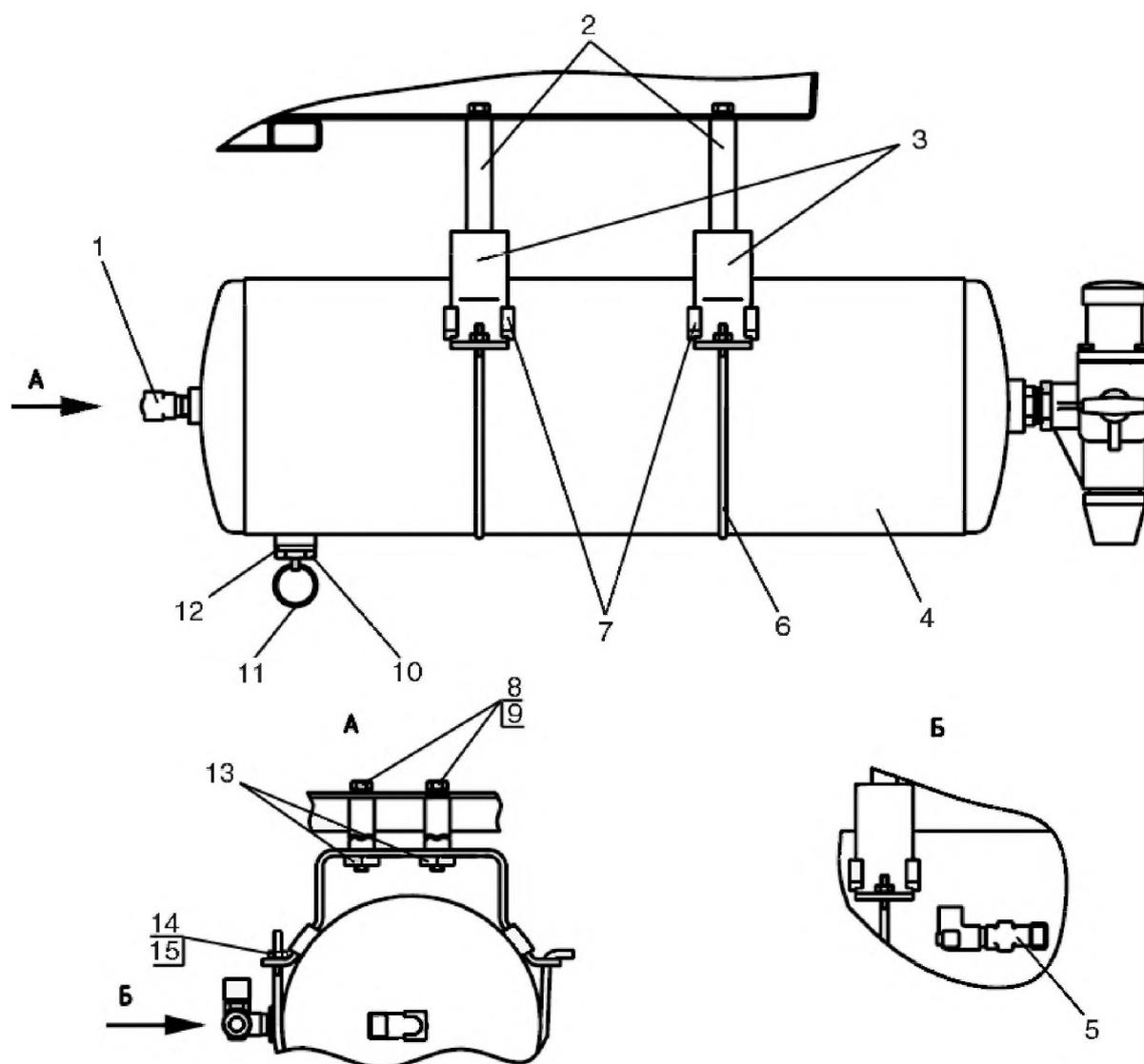
Рис. 35.7. Баллон (для двухпроводного пневмопривода тормозов прицепа)
