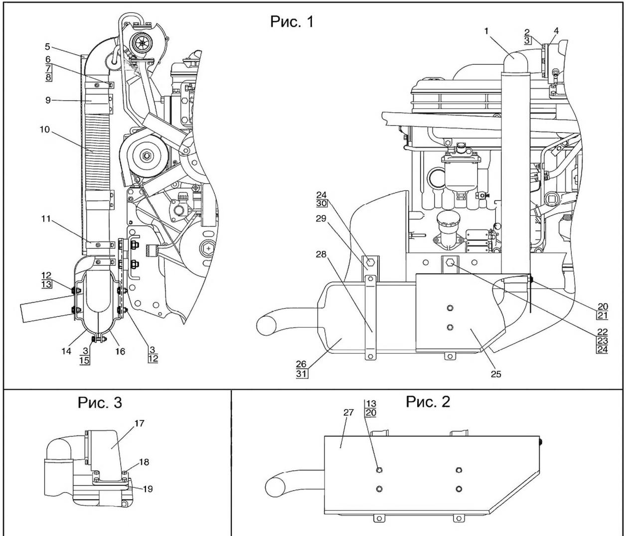
Рис.12.1. Глушитель. Установка глушителя
