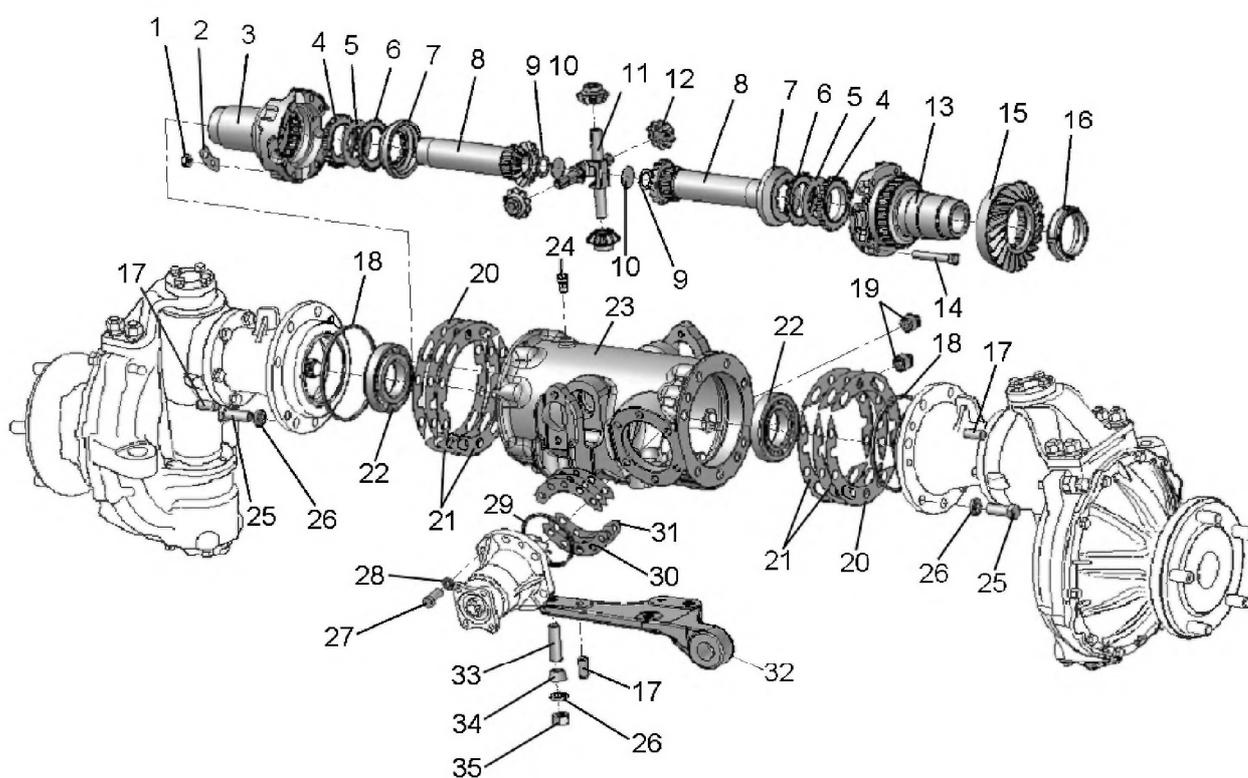
Рис. 23.1. Передний ведущий мост. Корпус переднего моста. Дифференциал
