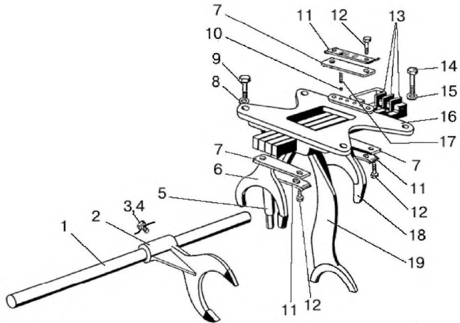
Рис. 17.9. Механизм управления механической КП. Корпус вилок
