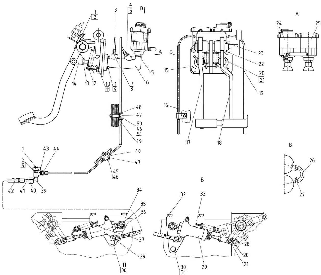
Рис. 35.2. Управление рабочими тормозами
