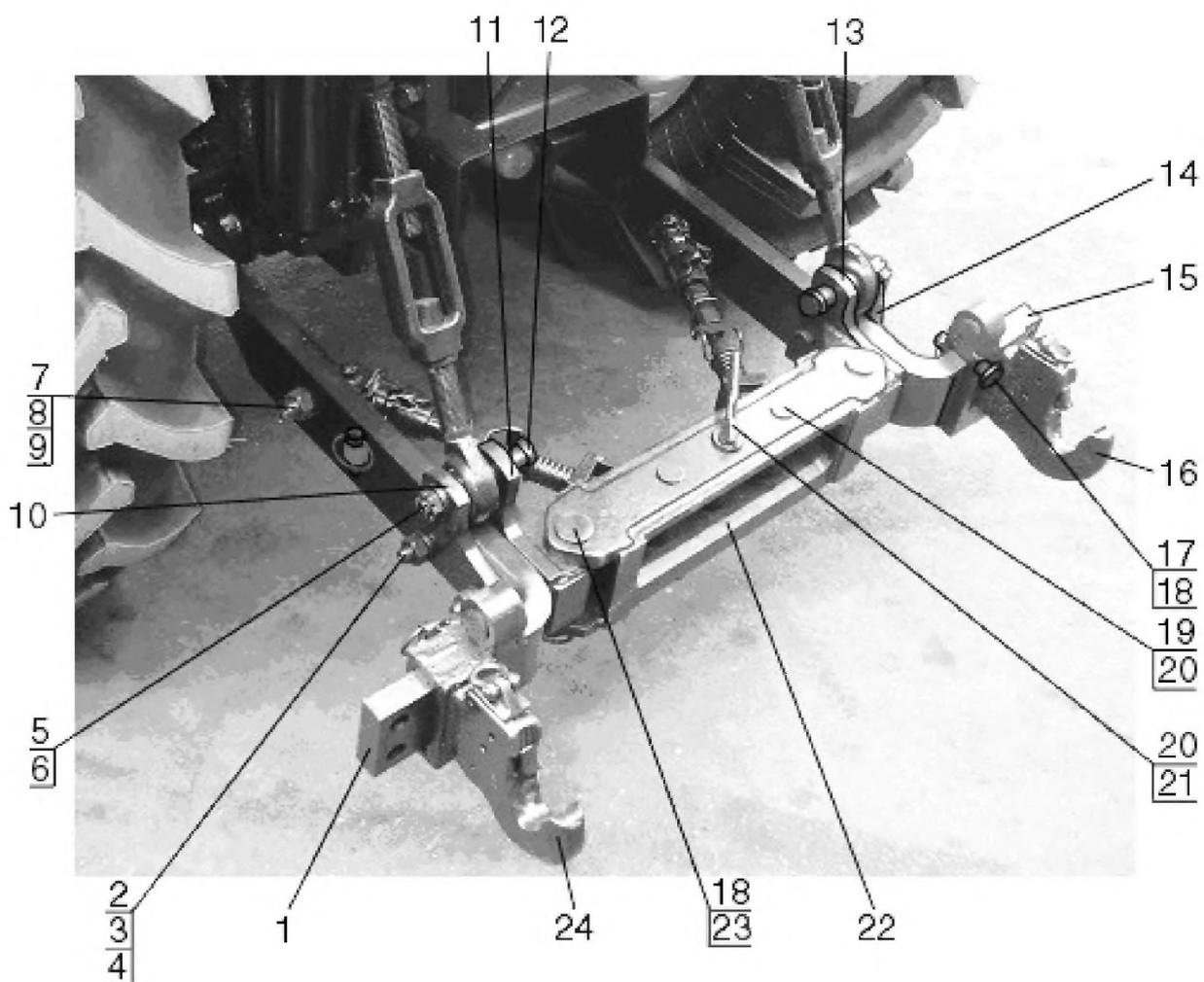
Рис. 46.10. Механизм задней навески
