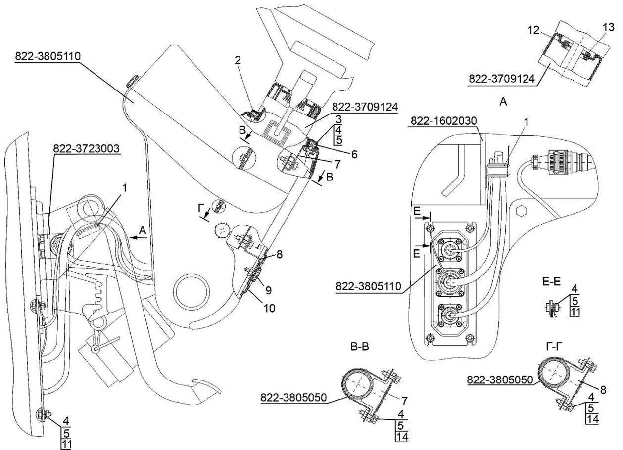
Рис. 38.1. Установка щитка приборов
