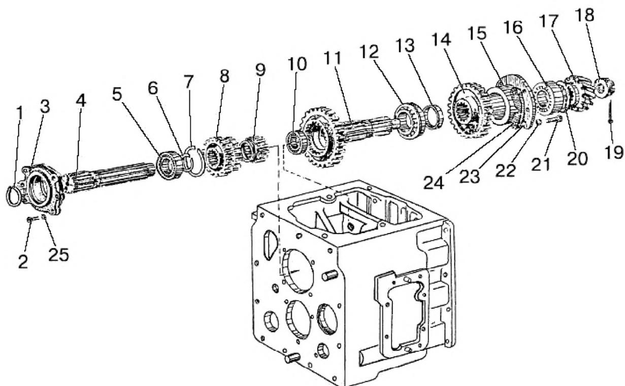
Рис.17.5. Вал первичный и вал вторичный механической КП
