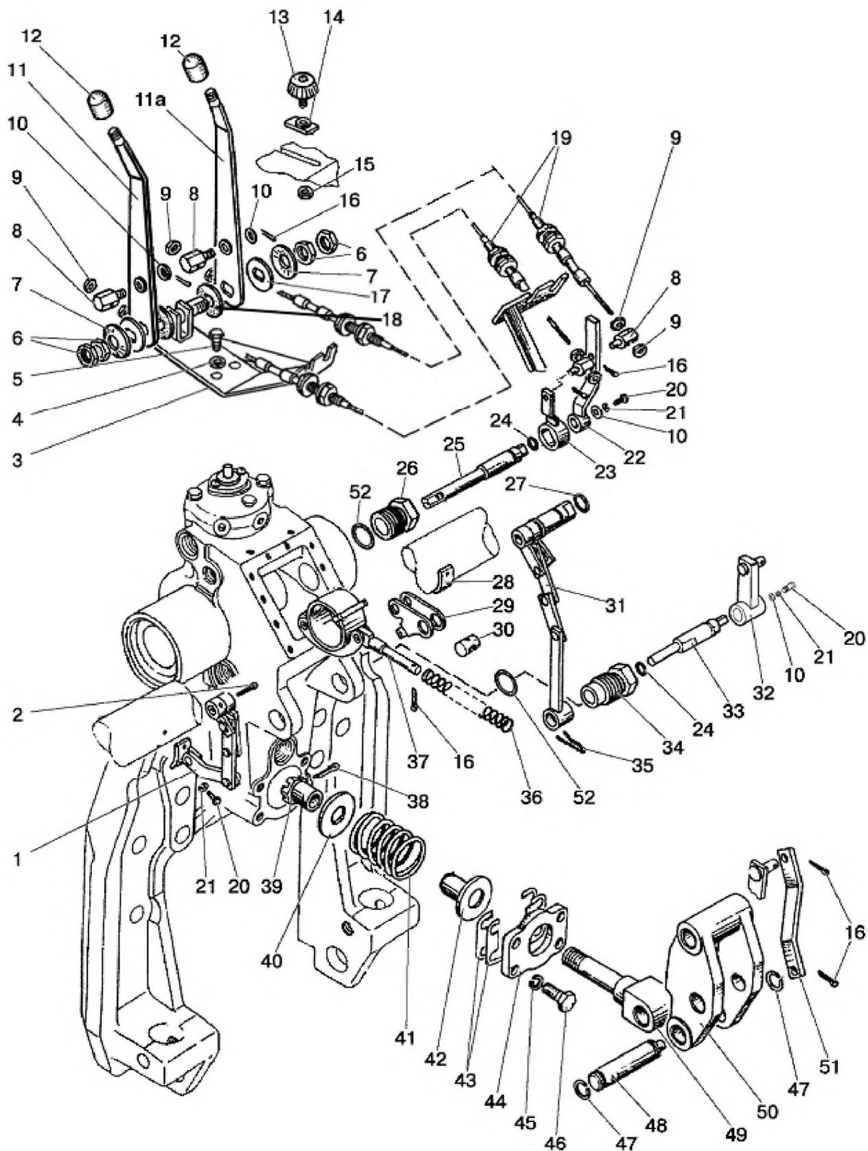
Рис. 46.8. Гидроподъемник. Управление гидроподъемником
