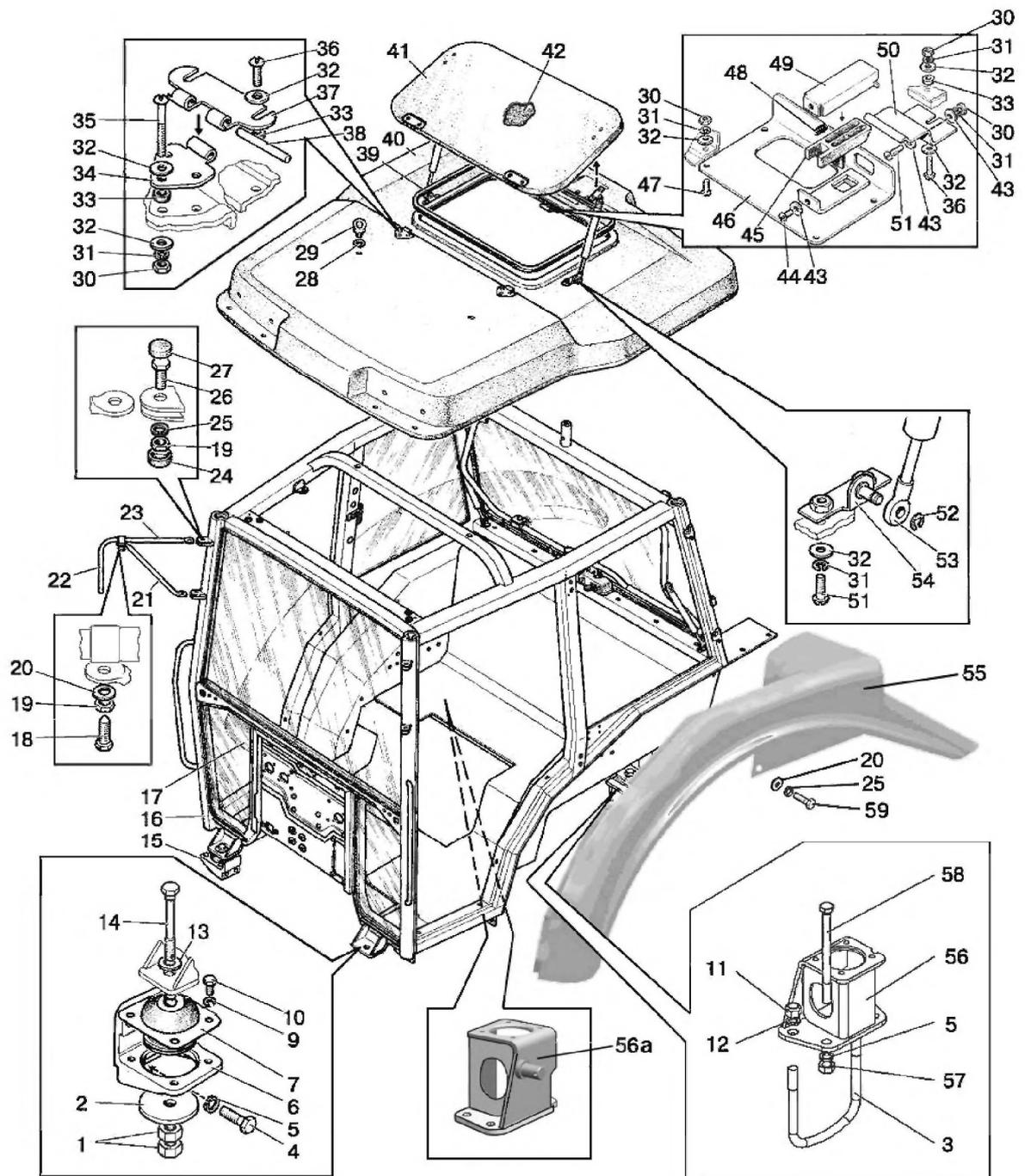
Рис. 67.2. Кабина трактора
