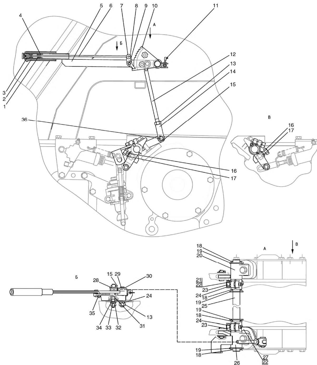
Рис. 35.3. Тормоз стояночный. Управление стояночным тормозом
