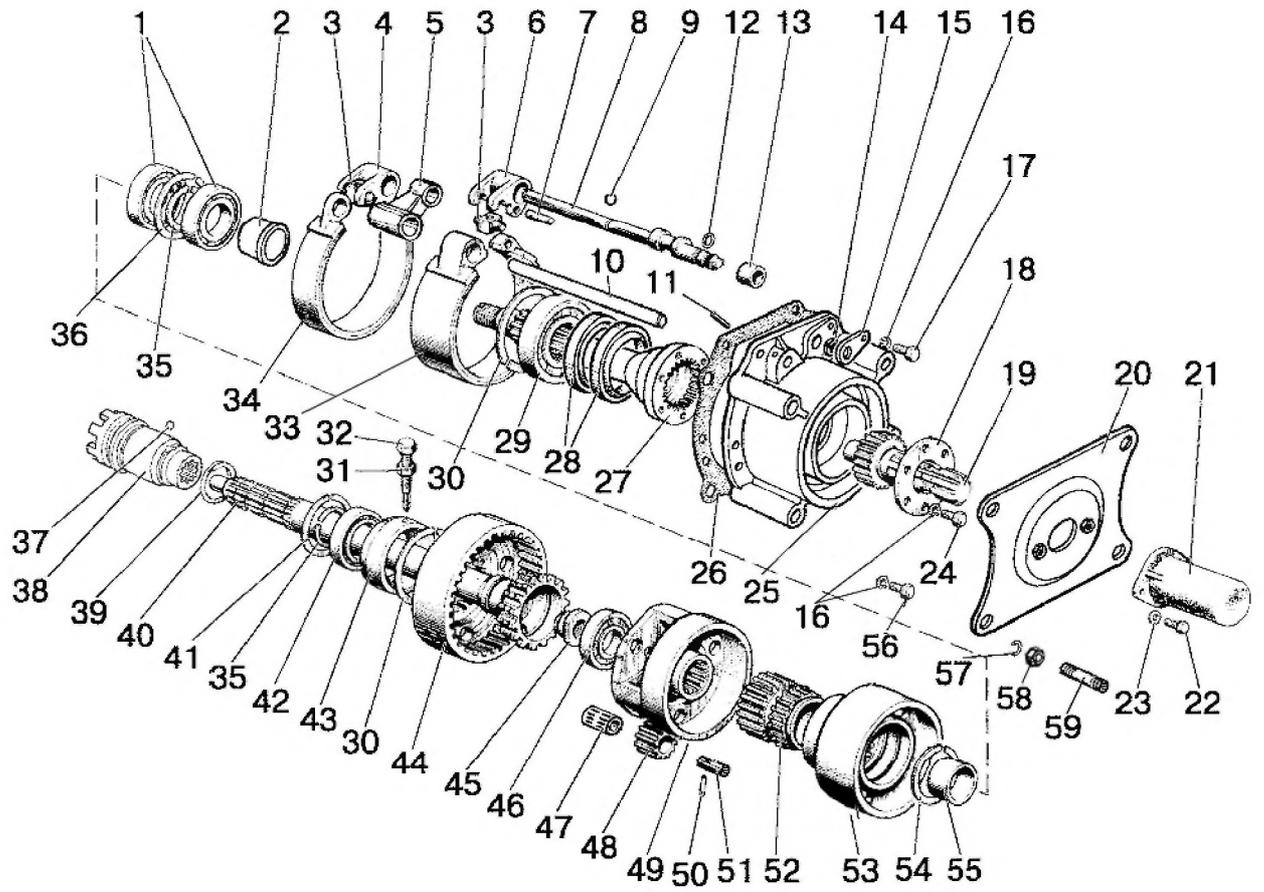
Рис. 42.1. Вал отбора мощности задний
