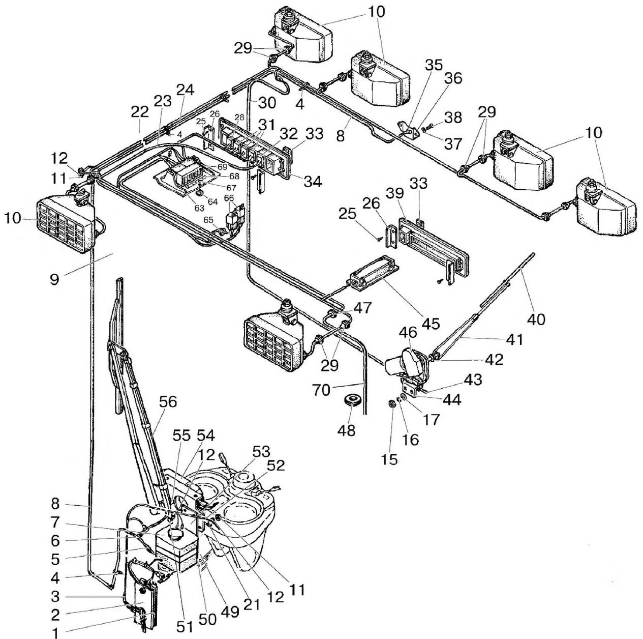
Рис. 37.4. Электрооборудование кабины
