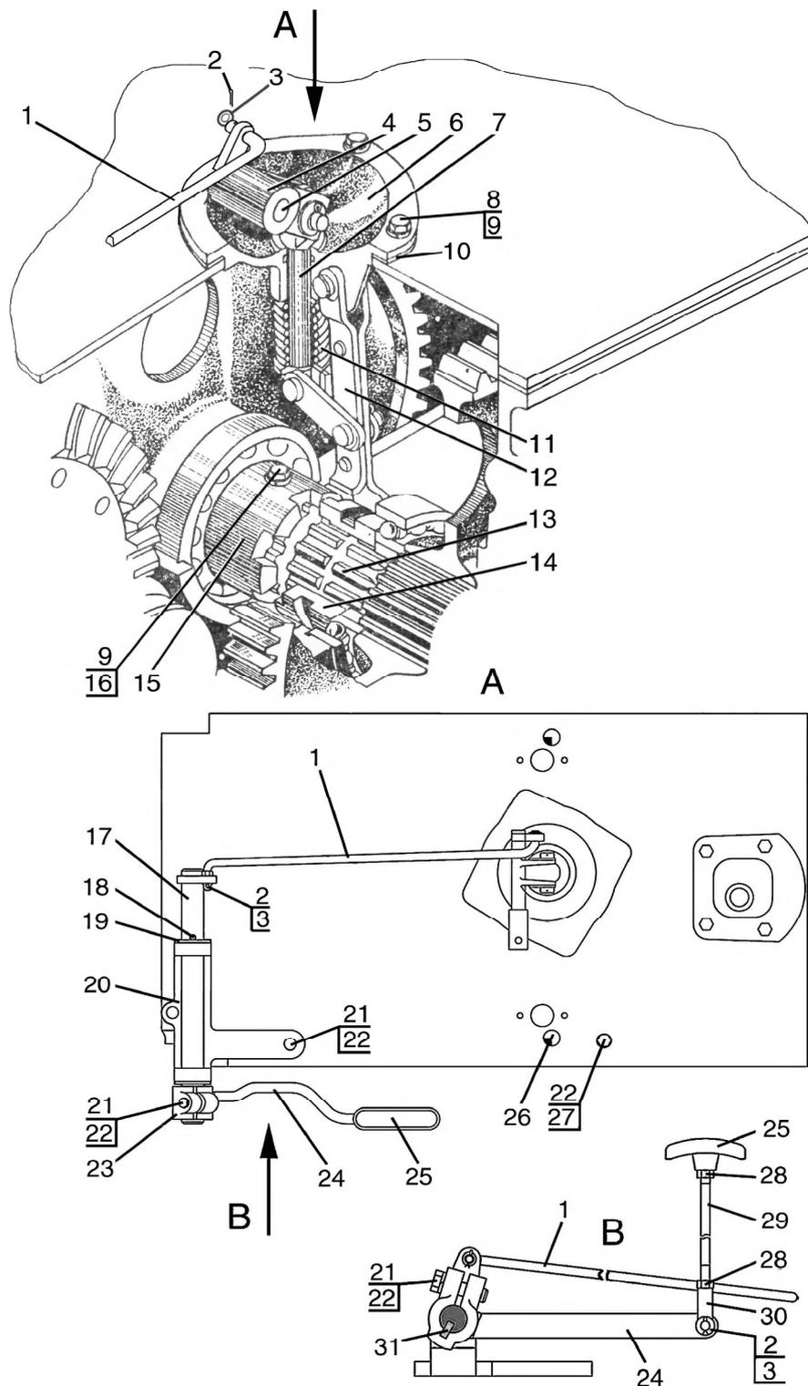
Рис. 24.4. Механизм блокировки дифференциала. Управление
