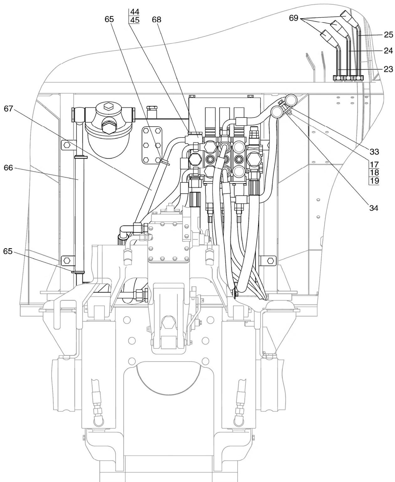
Рис. 46.3. Гидроагрегаты и арматура
