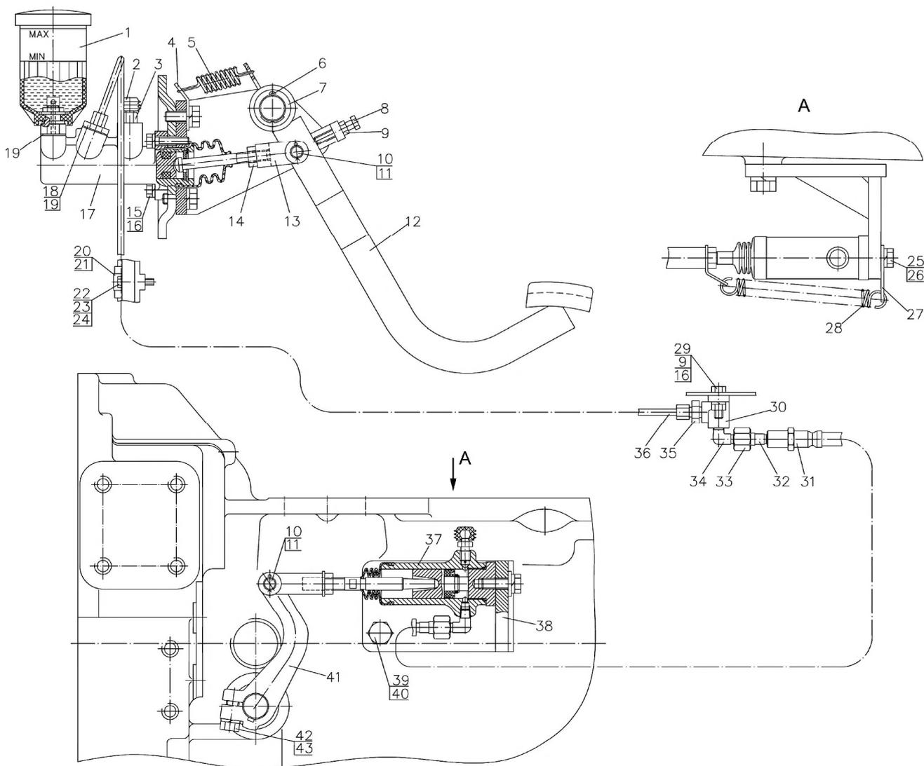
Рис. 16.6. Управление сцеплением
