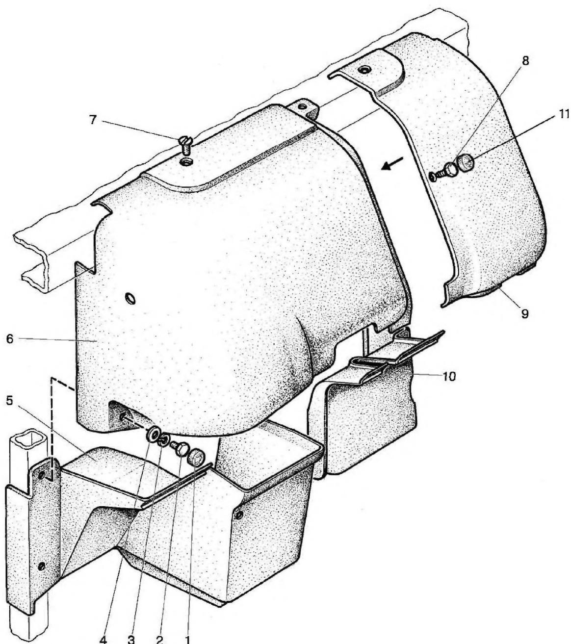
Рис. 67.5. Облицовка рулевой колонки
