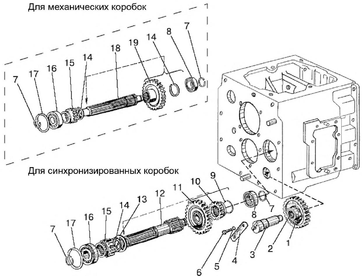
Рис. 17.8. Вал 1-ой передачи и передачи заднего хода
