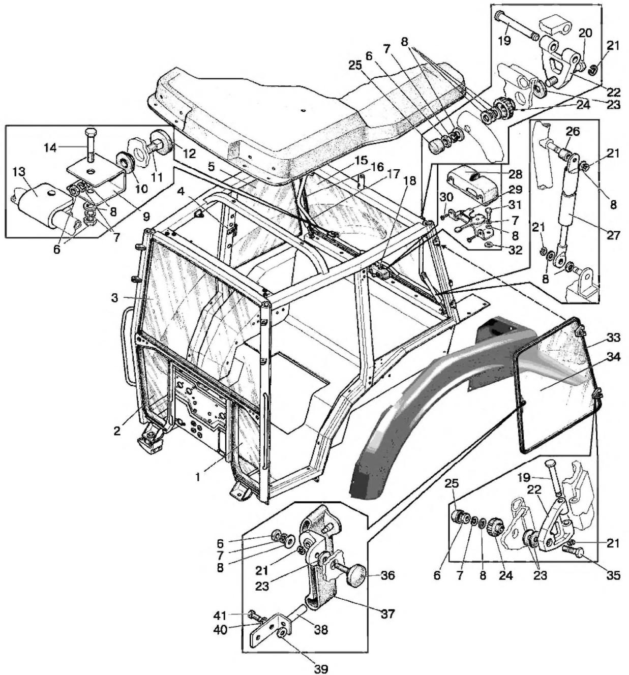
Рис. 67.1. Кабина трактора
