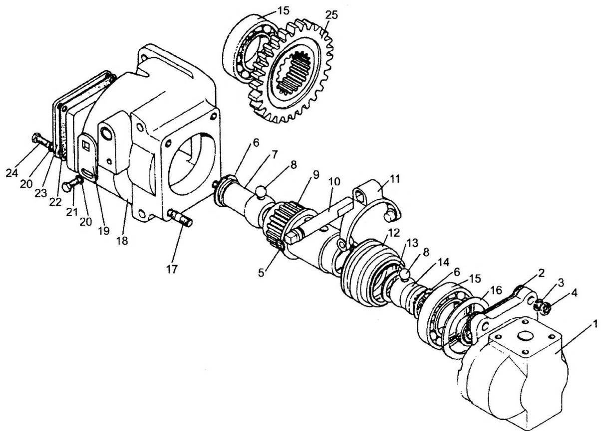
Рис. 46.5. Привод насоса гидросистемы
