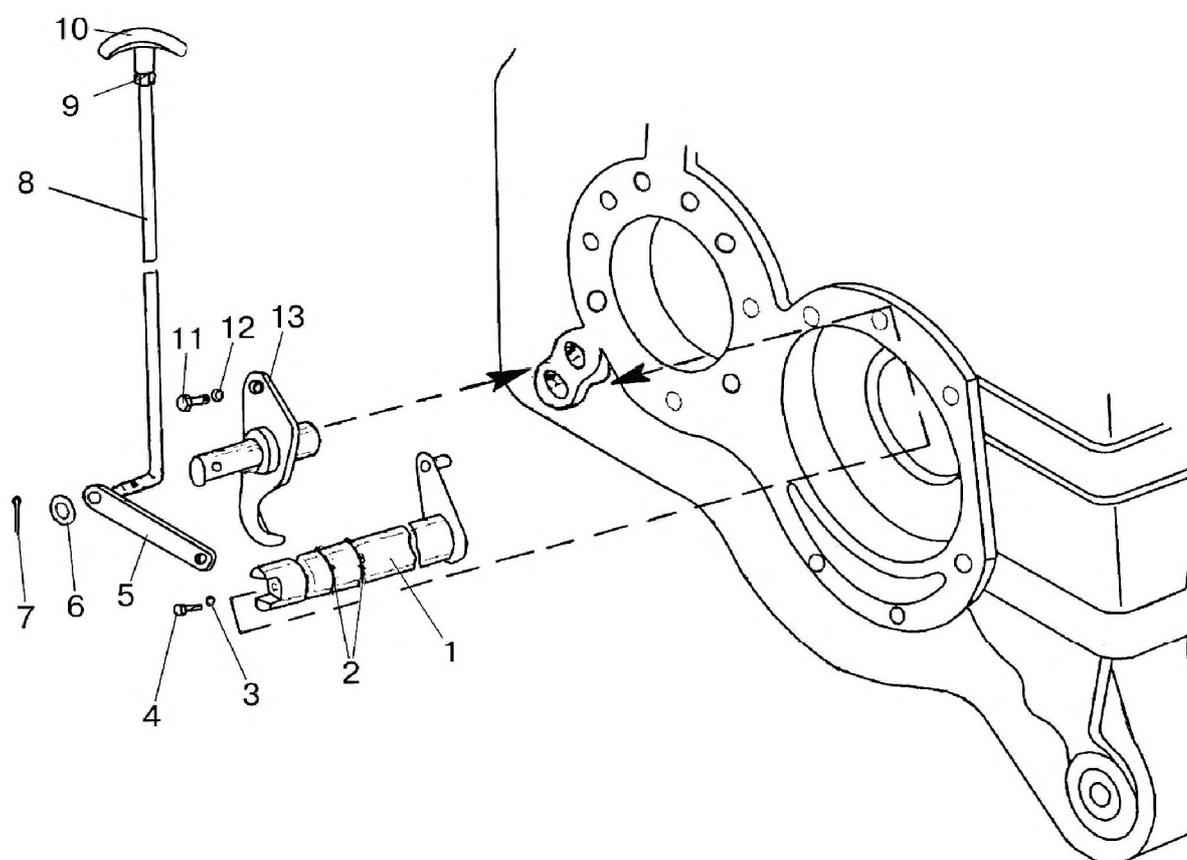
Рис. 24.3. Переключение ВОМ (независимый/синхронный)
