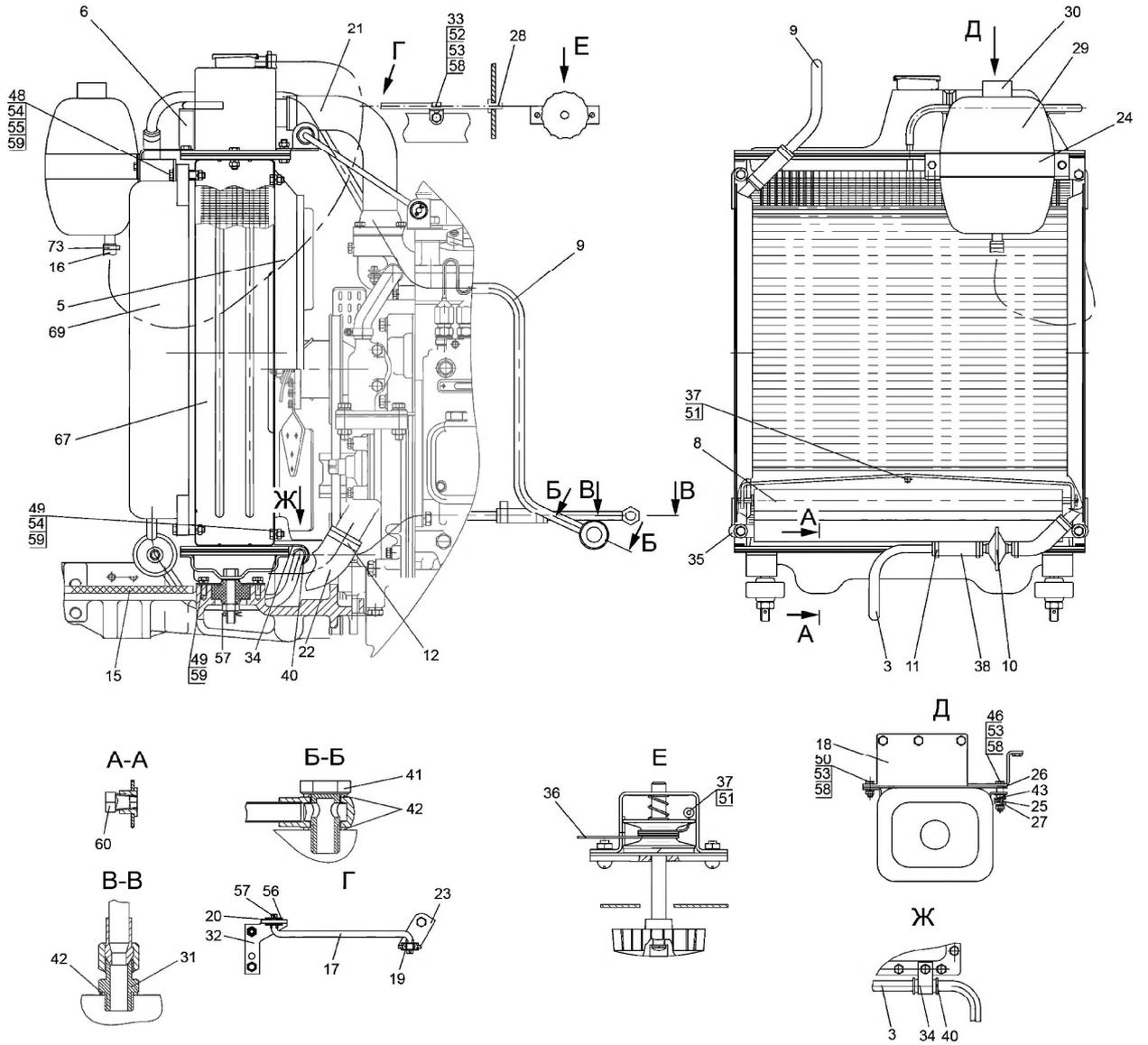
Рис.13.1. Блок охлаждения (для трактора «БЕЛАРУС-821/821.2»)
