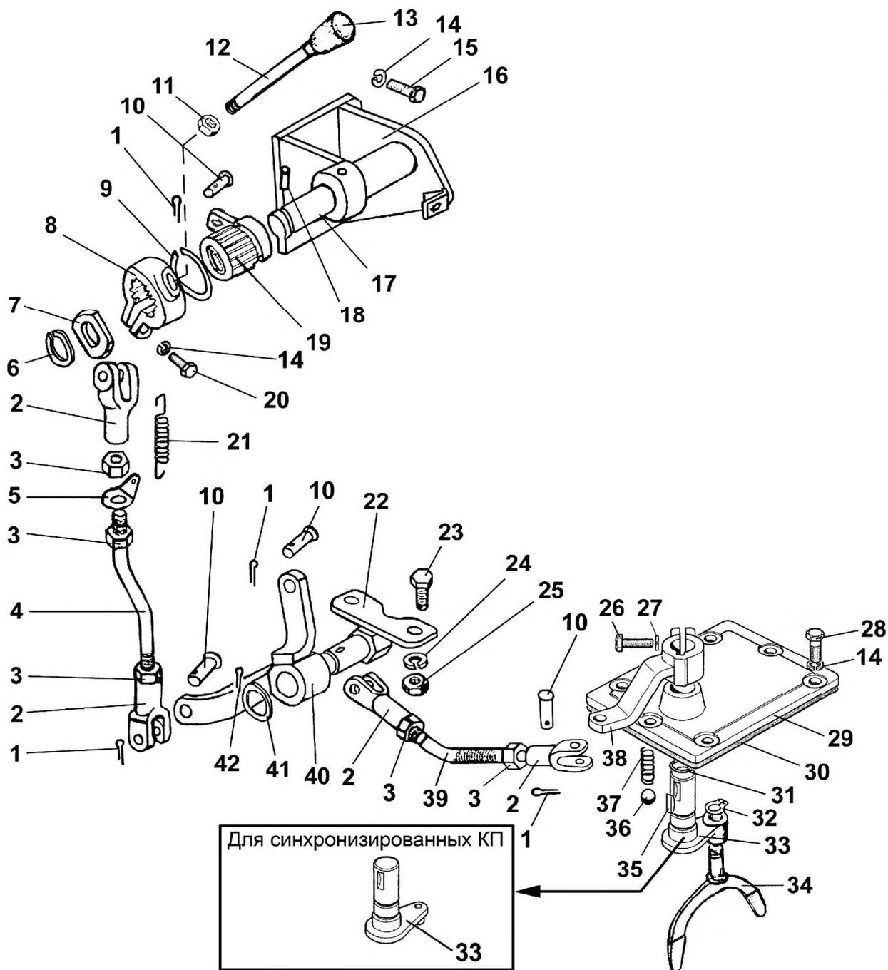
Рис. 17.3. Управление редуктором
